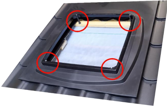
Kuva 4. Pohjaosan kiinnitys ruoteisiin, holkkien läpi ruuvatuilla ruuveilla.
