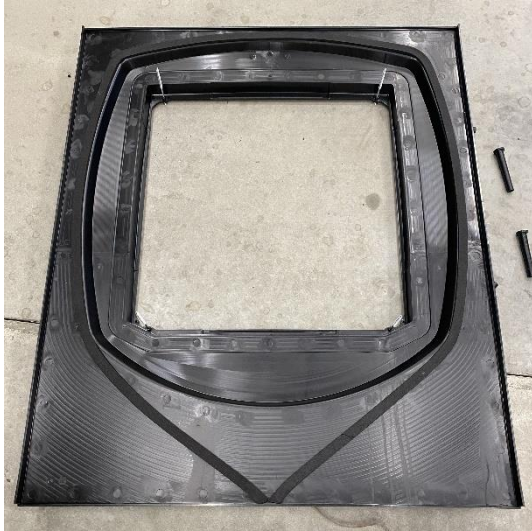
Kuva 3. Saumanauhan kiinnitys pohjaosaan
