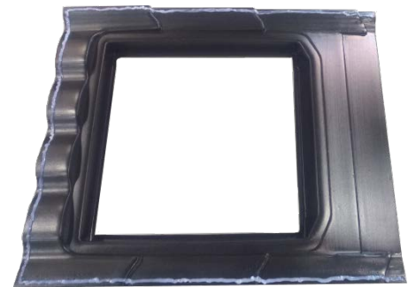
b. Pohjaosan pohjaan levitetty tiivistemassa. Huomioi, että esiporatut reiät jäävät tiivistemassan sisäpuolelle
