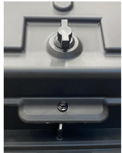
k. Kattoluukun lukitus ja ruuvivarmistus
