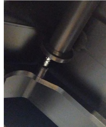
Kuva 9. Ruuvi paikoitettu oikein
