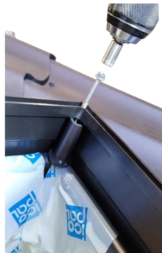
f. Kattoluukun kiinnitys pohjaosaan
