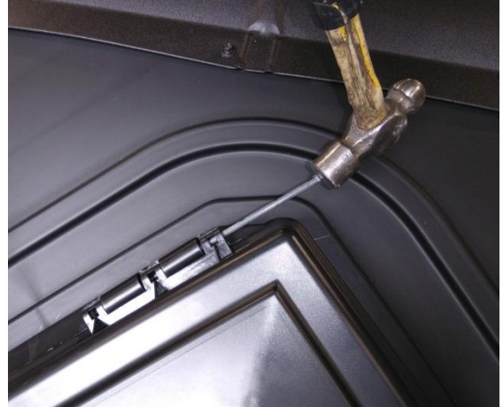
i. Saranatapin kiinnittäminen
