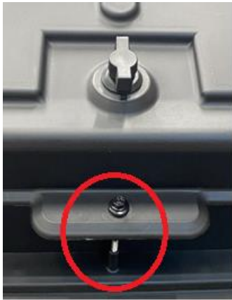
Kuva 9. Kattoluukun lukitus ja ruuvi varmistus
